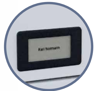
2,9-tommer e-paper skilt med elektronikk for oppdatering av tekst
